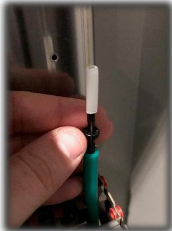
Schieben Sie die mit der ELF gelieferte Schutzhülse über.
