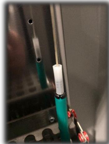
Drücken Sie die Schutzhülse nach unten, um die ELF zu sichern. Die ELF ist jetzt aktiviert, und die Faser ist gesichert.
