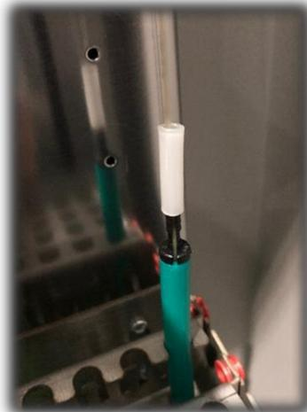
ELF mit der Oberseite in das Mikrorohr drücken, um die Zugentlastung zu aktivieren.
