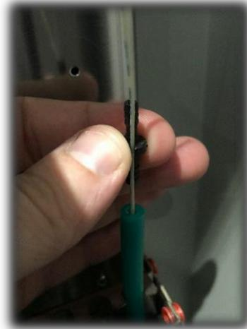
Stellen Sie den ELF-Zentralkanal mit der Fasereinheit in Reihe und drücken Sie die Faser in den Schlitz.
