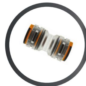
**Push-Fit-Steckfittings** sind für die Verwendung mit FibreFlow-Mikrorohren der gleichen Größe geeignet. Sie gewährleisten eine nahtlose und luftdichte Verbindung beim Einblasen von Glasfaserkabeln bei Arbeitsdrücken von bis zu 15 Bar.
