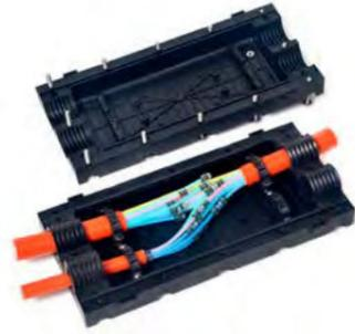
Die **H-Abzweigmuffe** zum sauberen Abzweig von 4 Mikrorohrbündeln mit 50 mm Außendurchmesser. Dank Sechskantschraubenverschluss wird die Schutzklasse IP68 erreicht. Die Muffe wird mit 50 mm-Blindstopfen geliefert.
