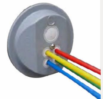
**Hauseinführung** für die schnelle und einfache Montage ohne Kernlochbohrung. Als Einfach-Version für die Einführung von je 1 Mikrorohr bis  $\varnothing 20$  mm in verschiedenen Versionen erhältlich. Als Mehrfach-Version für die universelle Einführung von 1-4 Mikrorohren bis  $\varnothing 12$  mm erhältlich.
