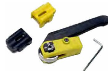
Der **Längsschnitt-Abmantler** entfernt die äußere Hülle eines Rohrbündels. Dank vier Einstellungen für die Klingentiefe und zwei in -kludierten Schutzvorrichtungen ergeben sich 12 mögliche Einstellungen für die Klingentiefe.
