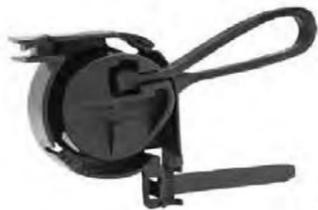
Die **Mini Anschlussklemme** ist komplett aus Kunststoff, UV-beständig Körper und hat ein werkzeugloses Design. Zur Sicherung runder Luftanschlusskabel mit einem Durchmesser von 3-4 mm, über Spannweiten von bis zu 70 m.
