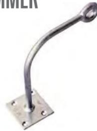
Erweiterte Hausanschlussklammer - 4 Löcher, verlängerter Ankerpunkt für zusätzlichen Abstand zu Hindernissen. Befestigung auf Außenflächen, Nutzung als Endklammer für Hausanschlüsse mit bis zu 40 m Spannweite.
