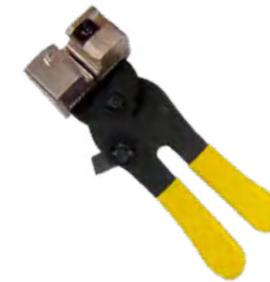
Das **Gewebe-Schneidwerkzeug** eignet sich zum Längsschneiden des Gewebes der achtförmigen Rohre zur Luftverkabelung von Emtelle.
