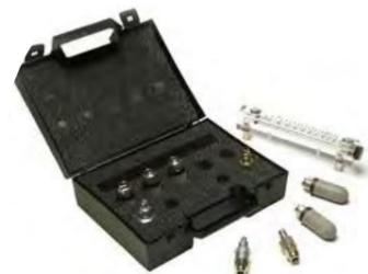
**Luftmengenmesser-Kit** mit sämtlichem Zubehör zur Messung des Luftstroms in Mikrorohren. Der Luftstrom muss ausreichend sein, um sicherzustellen, dass ein Kabel in Mikrorohre eingeblasen werden kann.
