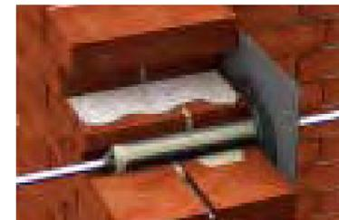
**Hauseinführung** für den waagerechten oder schrägen Einbau bis zu 45° Neigung. Durch bewährte Membrantechnik lässt sich die Hauseinführung auch in ältere Gebäude problemlos einbauen. Die Montage erfolgt in einer Bohrung von 25 mm absolut werkzeugfrei. Mit einer Füllmenge von 25 ml wird dank der dünnen Klebemanschette besonders wenig Harz benötigt.
