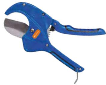
Der **Rohrschneider** zum Schneiden von Mikrorohrverbänden, HDPE-, PVC-Kabelschutzrohren oder anderen nichtmetallischen Rohren bis AD 64 mm. Ratschen-Mechanismus und Einhandbedienung für große Hebelwirkung und müheloses Schneiden. Die dreieckige Klinge sorgt für rechtwinklige und gerade Schnitte.
