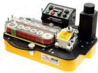
**Airstream** Kabel-Einblasmaschine mit elektrischem Antriebsmotor zum Einblasen mittelgroßer Kabel in Mikrorohre. Geeignet für Mikrorohre von 5-18 mm Durchmesser und Kabel von 2,5-11 mm Durchmesser.
