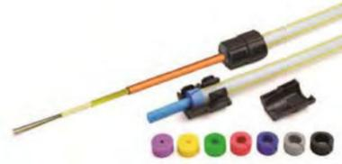
Gas- und wasserdichte **Einzelzugabdichtung** zur Abdichtung zwischen Mikrorohr und Kabel im Gebäude und NVT. Gas- und wasserdicht bis 0,5 bar. Für die nachträgliche Montage geeignet. Schlanke Bauform. Gummidichtungen mit Farbcodierungen zur genauen Zuordnung des Kabels.
