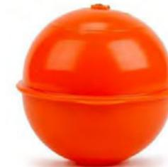
Mit **Kugelmarkern** markiert und ortet man unterirdisch verlegte Leitungen oder relevante Punkte wie den Hausanschlüsseabzweig. Frequenz Telekommunikation: 101,4 kHz
