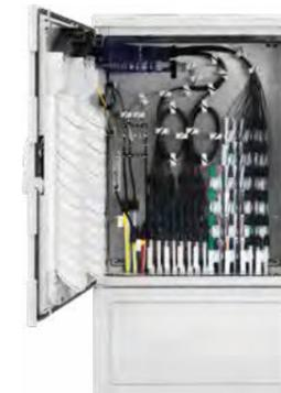
Netzverteiler mit Gehäuse aus Polycarbonat und hoher Schutzklasse (IP54) zur Aufnahme ankommender und abgehender Mikrorohre/ Kabel. Spleißkassetten zum Glasfasermanagement separat zur Mikrorohrablage angeordnet für übersichtlichere Installation. Unterschiedliche Versionen verfügbar zur Aufnahme von bis zu 648 bis zu 2.448 Spleiße.
