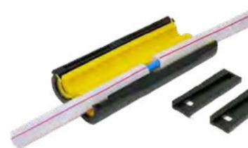
**Teilbare Reparatur- und Einblasmuffe** zur gas- und wasserdichten Abdichtung bei beschädigten Mikrorohren, wenn diese bereits mit einem Glasfaserkabel belegt sind. Durch den flexiblen und anpassungsfähigen Silikondichteinsatz, der fest auf das beschädigte Rohr gepresst wird, wird das beschädigte Rohr zuverlässig mit 0,5 bar abgedichtet.
