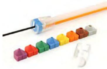
Gas- und wasserdichte **Einzelzugabdichtung** zur Abdichtung zwischen Mikrorohr und Kabel im Gebäude und NVT. Gas- und wasserdicht bis 0,5 bar. Für die nachträgliche Montage geeignet. Schlanke Bauform. Gummidichtungen mit Farbcodierungen zur genauen Zuordnung des Kabels.
